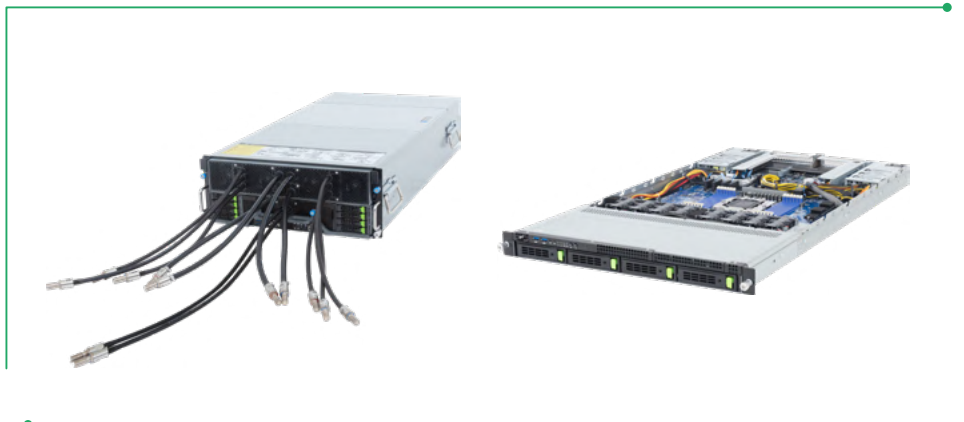
▲ 左：直接液體冷卻 AI 伺服器 (G4L4-SD1-LAX5) / 右：ARM64 架構伺服器 (R1A3-T40-AAV1)
